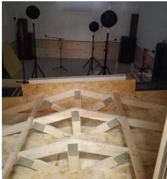
Abb. 5: Im Dachrahmen eingebautes Nagelplattenbinder-Dachsystem ohne Eindeckung (senderaumseitig)
