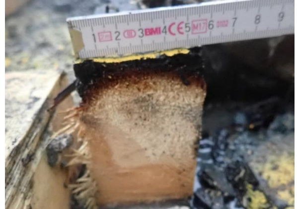
Bild 7.16: Restquerschnitt Ständer 7 - horizontal
