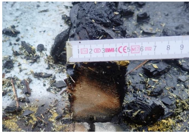
Bild 7.10: Restquerschnitt Ständer 4 - horizontal
