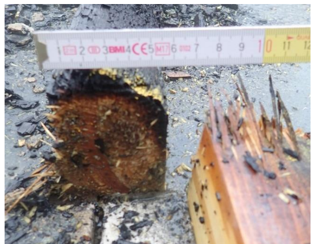
Bild 7.6: Restquerschnitt Ständer 2 - horizontal
