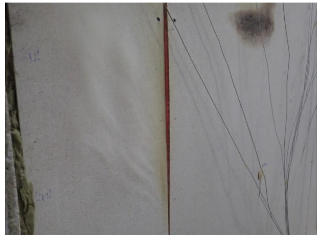
Bild 6.12: Prüfminute 92 – Öffnung der vertikalen Fuge im Bereich der Verfärbung.
