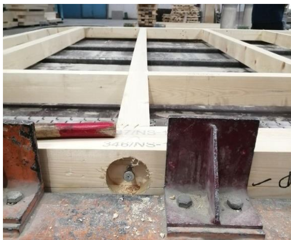
Bild 5.5: Transportankerschrauben \varnothing 12,0 x 120 mm.
