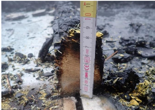
Bild 7.9: Restquerschnitt Ständer 4 - vertikal
