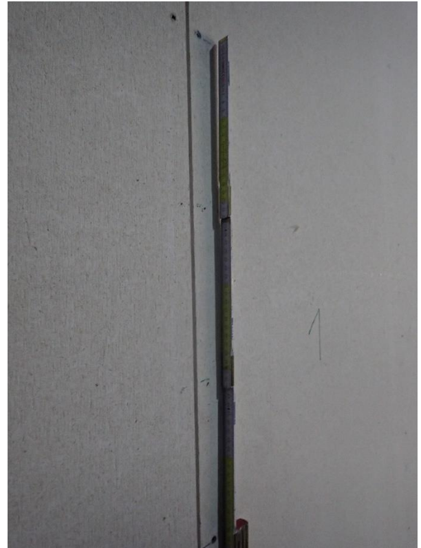
Bild 5.14: Befestigungsmittelabstand der Schrauben und Klammern, feuerabgewandte Seite.
