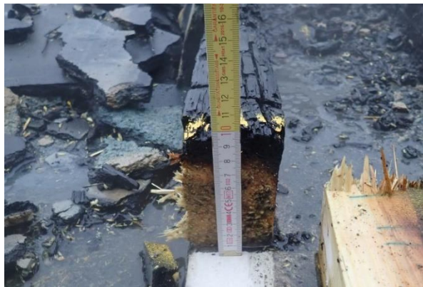
Bild 7.3: Restquerschnitt Ständer 1 - vertikal
