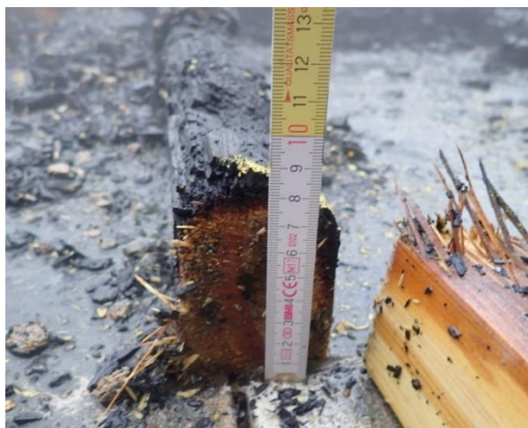
Bild 7.5: Restquerschnitt Ständer 2 - vertikal
