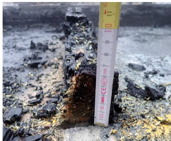
Bild 7.11: Restquerschnitt Ständer 5 - vertikal
