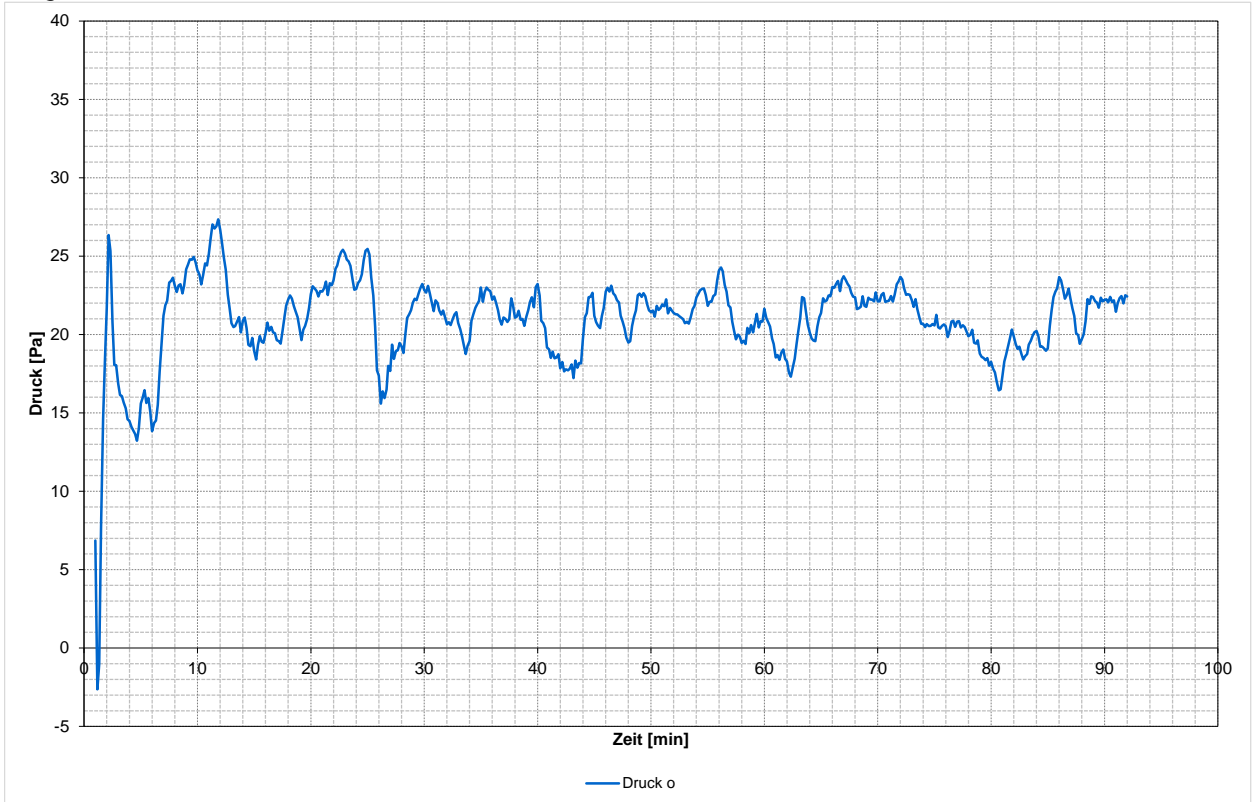
Diagramm 3.4 Druck im Brandraum
