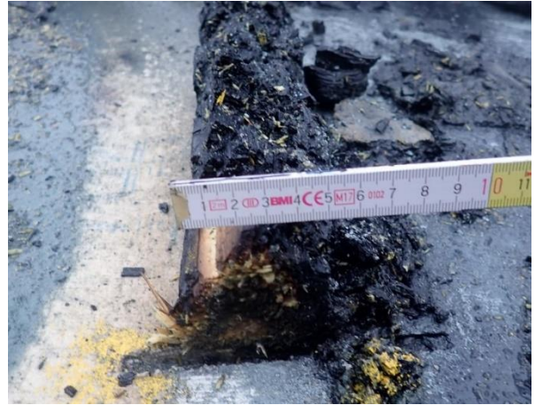
Bild 7.8: Restquerschnitt Ständer 3 - horizontal
