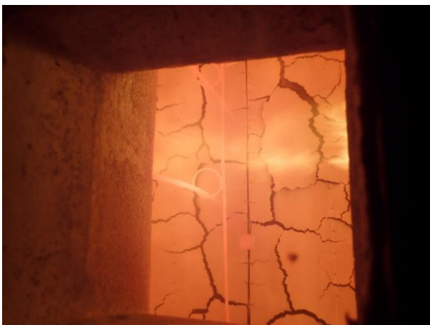
Bild 6.5: Prüfminute 48 – Plattenstücke der äußeren Lage stehen weit ab.
