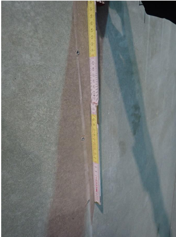
Bild 5.13: Befestigungsmittelabstand der Schrauben, feuerzugewandte Seite.
