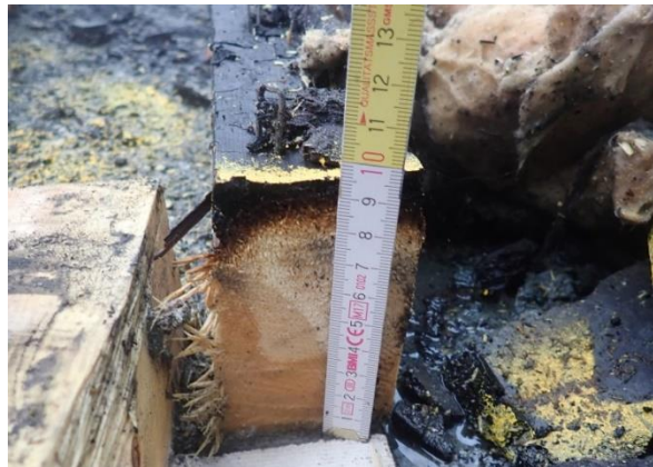
Bild 7.15: Restquerschnitt Ständer 7 - vertikal
