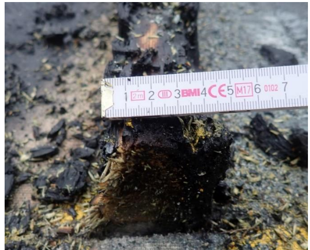
Bild 7.12: Restquerschnitt Ständer 5 - horizontal
