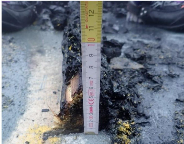
Bild 7.7: Restquerschnitt Ständer 3 - vertikal
