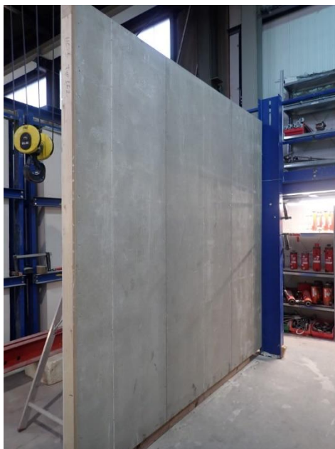
Bild 5.11: Ansicht Wandkonstruktion, feuerzugewandte Seite.
