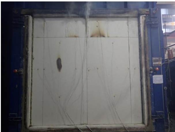
Bild 6.11: Prüfminute 86 – Dunkle Verfärbung der Gipsfaserplatte.
