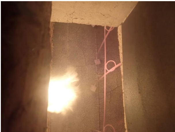
Bild 6.3: Prüfminute 17 – Kreuzrisse und engmaschige Rissbildungen auf der Plattenoberfläche.
