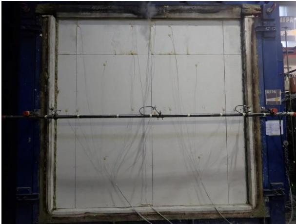
Bild 6.9: Prüfminute 75 – Zunehmender Rauchaustritt und Verfärbung der Fugen im oberen Bereich.
