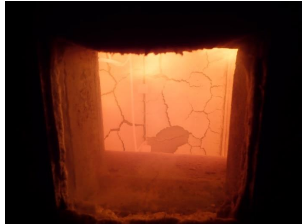
Bild 6.8: Prüfminute 57 – Weitere Plattenstücke der äußeren Lage lösen sich und Riss in innerer Lage.
