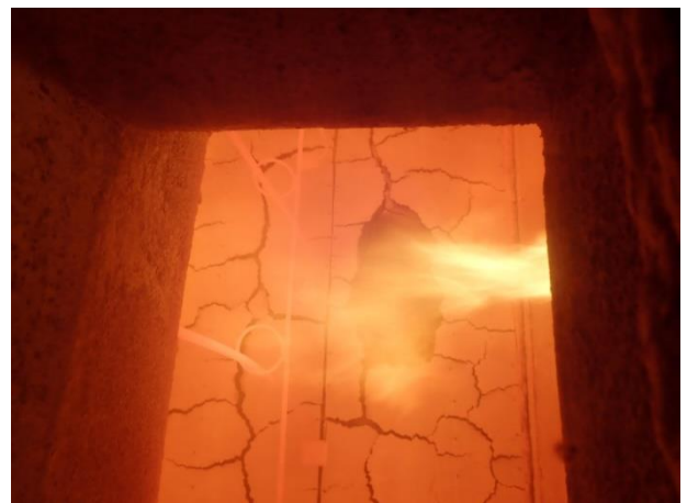
Bild 6.6: Prüfminute 53 – Plattenstück aus äußerer Plattenlage abgefallen.
