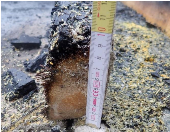
Bild 7.13: Restquerschnitt Ständer 6 - vertikal
