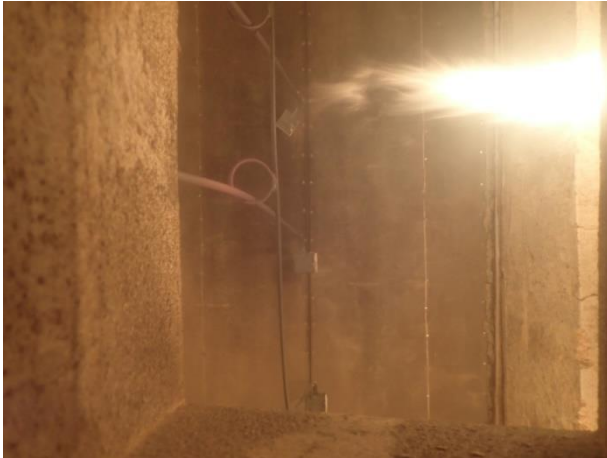
Bild 6.1: Prüfminute 5 – Dunkle Verfärbung der Plattenoberfläche.
