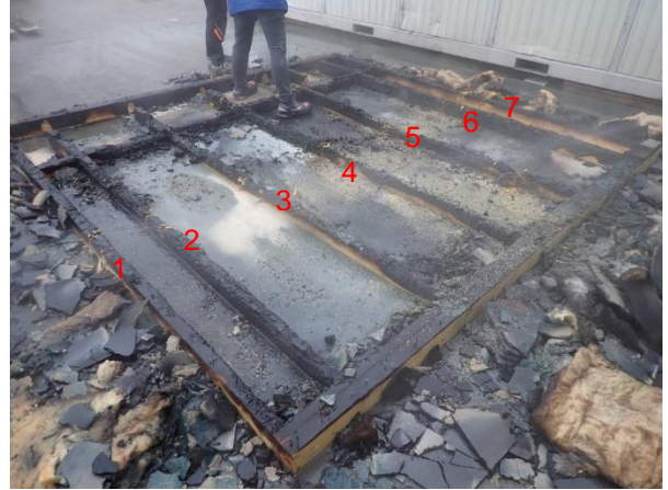
Bild 7.2: Probekörper nach Rückbau aus dem Prüfofen und nach dem Löschen.
